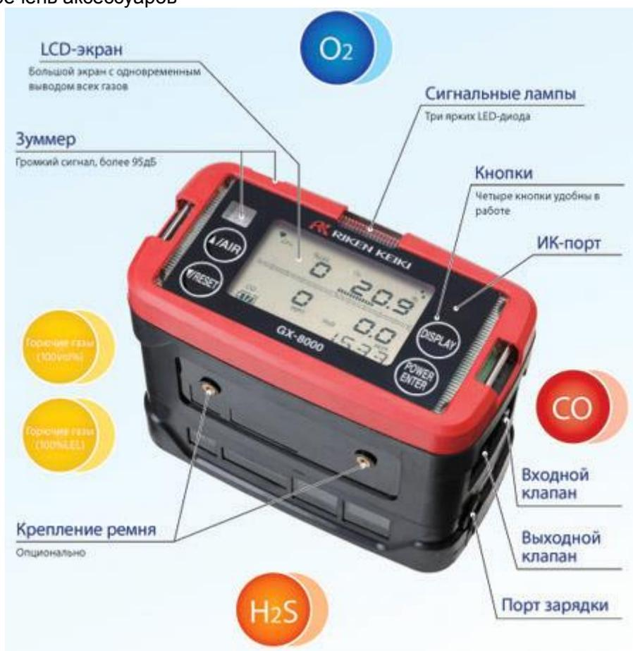
Как можно видеть на изображении, расположенном выше, прибор оснащен большим удобочитаемым LCD-экраном, на котором, в дополнение к символам газов и концентрации, отображаются символы, позволяющие судить об исправности прибора в целом и насоса в частности, а также цифровая шкала уровня расхода. Кнопки адаптированы под управление в рукавицах. При желании прибор оснащается ремнем, который позволяет закрепить GX-8000 на поясе, полностью освободив руки.
