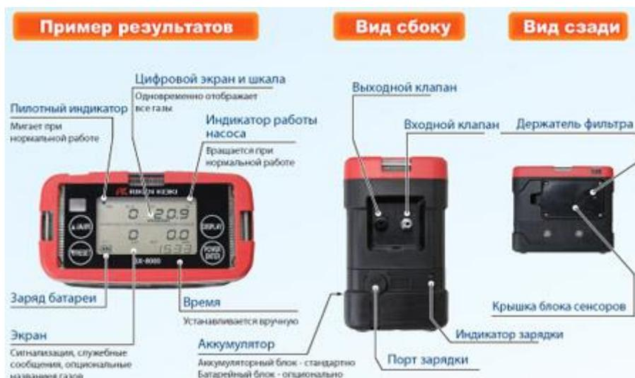
Прибор имеет функцию впр-теста, которая позволяет протестировать устройство перед заступлением на смену. Для удобства управления парком газоанализаторов в GX-8000 предусмотрена функция присвоения идентификатора в пределах от 0 до 999.
